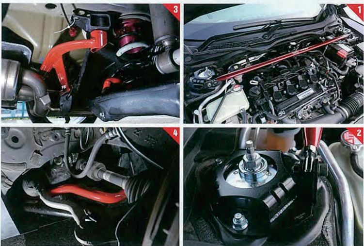
①②フロント3Dタワーバー(2万9700円)はブラケットに3点支持補強を加える特殊形状を採用することで路面からの突き上げを受け止めるサスペンションタワーの強度をアップ。サスの動きをしっかり把握できる。 ③④前後のスタビライザー(F=3万4100円/R=2万9700円)はねじりの抑制もあるが、前後の動きのバランスを整えて、ステアリング操作に対してクルマの一体感を高める。フロアブレスは写真のリア(2万7500円)以外にフロント(3万7400円)にも装着。フロントは純正の補強プレートを外すことなく、取り付けが可能。形状だけでなく、構造も考慮され、軽量と高剛性を両立させている。補強パーツはFK8にも装着可能だ。
