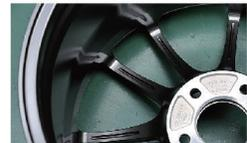
スポークをスリムに仕上げるだけでなく、裏面のわずかな肉厚までも肉抜き処理。解析で剛性確保に要求されていた断面積はショットピーニング処理でスポーク裏面の裏面を鍛え上げることにより、13%削減を果たしている。
