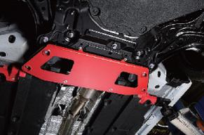
ハンドリングや乗り心地などを高めるために、ボディチューニングも精力的に図るSUSTEC。スポーツカーやスポーツグレードのボディチューニングパーツはSUSTECで展開されているが、強固なプレート形状で左右を結ぶアンダーブレースの開発アプローチはGTのものと言っている。
