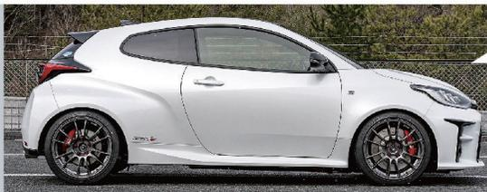
今回はサーキット走行なので前後45mmダウンとしたが、最低地上高を考えるとストリートでは前後25mm~30mmダウンになるとの判断。開発済みのSUSTECアンダープレースがクリアランスにどう影響するかも踏まえて推奨車高を決めている。
