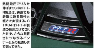
熱間鍛圧でリムを伸ばすSSRのFFT-R製法は、鍛造でも鍛造に迫る剛性と軽さを実現する。GTX04はFFT-R製法の採用だけでOKとせず、さらなる軽さとつながるインナーリムの見直しも図ってきた。
