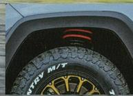
車高調よりローダウンは掛けられたが、純正と比べるに明確にアップしているため、まずはスプリングから交換でも、十分サマになる
