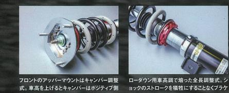
フロントのアッパーマウントはキャンバー調整式。車高を上げるとキャンバーはポジティブ側に傾くので矯正してやりたい
