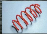
リヤ側は純正同様の構造形状。溶接製法によってならかな形状に成形されておりバネシートも穏やかに立ち上がりてくる
