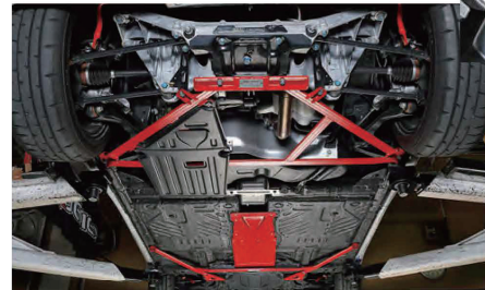
前後ともシャフト部分はタナベのラインアップするアイテムと同様だが、ベースプレートには剛性向上を図る3D形状を採用したS660用タワーバー。
