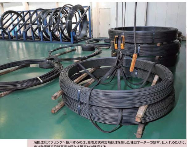
冷間成形スプリングへ使用するのは、高周波誘導加熱処理を施した独自オーダーの線材。仕入れるたびに、自社計測機で設計基準を満たす硬度かを確認する。
