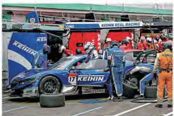
古くはF2000、今はスーパーGTと多岐なモータレースにレーシングホイールを供給してきたSSR。現在、スーパーGTで使用されているホイールの基本デザインは10スポークから改良され変わらないまま、実はチムカウの要望を反映させつつ毎シーズン細かなアップデートが図られている。剛性が高すぎればタイヤの摩耗が早くなるため、トーフラギーにならではのデータモードもハブとして蓄積され、ストリートホイールの開発開始時に反映させていくのだ。
