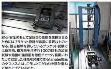
安心・安全のもとで定回りの性能を発揮させるためにはブラケット設計が非常に重要なものとなる。独自基準を課しているブラケット試験では縦方向、横方向それぞれ100万回もの加振試験や溶接の強度面を徹底チェック。長期にわたって安定した性能を発揮できるtanabe製品のタフネスさは、こうしたこだわりを積み重ねて築き上げているのだ。
