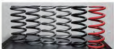
tanabeのカスタムスプリングはコイルング、低温ブルーイング（低温焼き）で、ダブルシャットピーニング、パッチング、下地処理に粉体塗装と多数の工程を経て仕上げられる。出荷前の最終検査はもちろんだが、各工程においても自由長など設計通りの仕上がりになっているかを全数チェック。製品に絶対的な自信を持っているからこそ、カスタムスプリングのSUSTEC、GT、DEVIDにはへたり永久保証が与えられているのだ。
