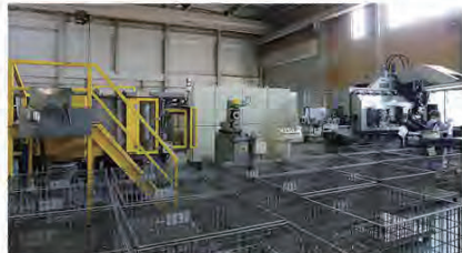
スプリング性能の理想を追求する中でたどり着いたのが、高強度や耐へたり、軽量で自由度の高い設計が可能な冷間成形だ。アフターパーツメーカーでは唯一となるハイパワーコイルングマシンを滋賀工場へ導入し、2100N/個もの引っ張り強度を誇るカスタムスプリングを生産させた。溶接仕上げから生産工程、品質管理まで一切の妥協を許さず生み出していく。タナベこだわりの製品。ダウンサスや車高調に採用するストリート用はもちろん、レース用も同じ生産ラインを使用する。
