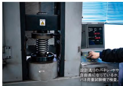
設計通りのパネレートや自由長になっているか、パネ荷重試験機で検査。
