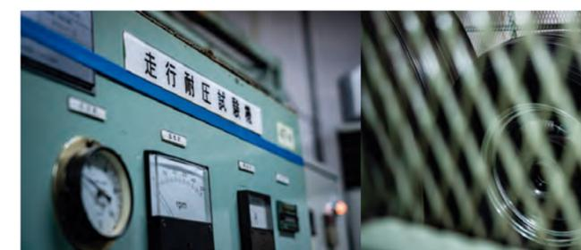
取材時は走行耐圧試験を実施していた。JWLの規格では50万回転で十分とされているが、SSRはより厳しい独自の条件を追加した上で、それを上回る60万回転させる。ここまでやるからSSRの製品は絶対的な信頼性を誇る。
