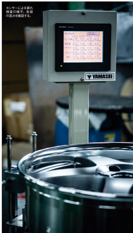
センサーによる振れ検査の様子。各部の歪みを確認する。
