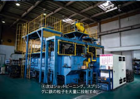
④次はショットピーニング。スプリングに鉄の粒子を大量に投射する。
