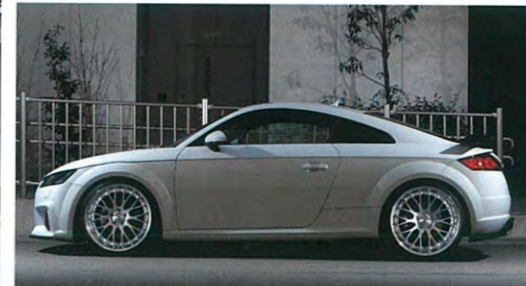
純正ステップ下に取り付けるサイドディフューザー。絞り込んだカナード形状がリア側に向かって膨らみながら立ち上がる。フロントバンパーとリアサイドディフューザーとのボトムを合わせている。
