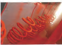
製品へのこだわりはバネへのリソ加工。カチオン電着塗装、粉体塗装とで実現化する。一般的には、ここまで手をかけて作れることはないという。
