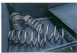
こちらはダブルショットピーニングの工程を終えたバネ。表面に入れるセラツツが、疲労強度が上がったことの動かし難い証拠だ。
