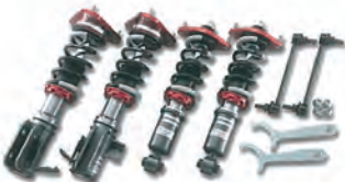
タナへの現役最速車高調。それが「GTフロントライドダンパー」だ。全長調整を採用し、コイルスプリングはもちろん冷間製法で作られ、ダブルショットピーニング、カチオン電着塗装と粉体塗装、同社の技術でアルケルで塗られている。スプリングの上下にサイレントブラーを巻いて、音漏れ防止する編組もアリ。アブソルバーは40段調整式。専用ゴムアッパーマウント付き。17万3800円。
