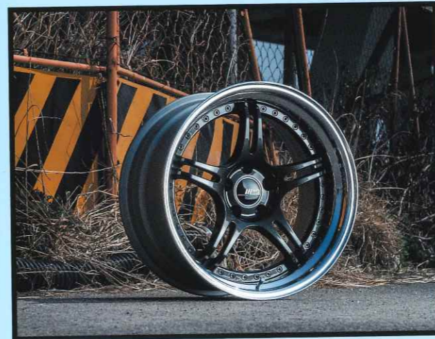
デュアル5本スポークのSPXは、動きのあるディスク形状が特徴。シリーズのなかで最深のコンケイブディスクを採用したモデルで、スタンダードとスーパーコンケイブではディスクの高低差が24.1mmもあり、前後で表情の違うディスクを装着できる。
