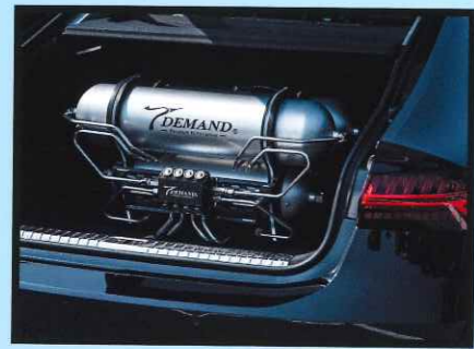
トランクに置かれたティーデマンドのハードラインバッテリーの3タンク。溶接なしのシームレスなエアタンクとバイピングがスリキリとシメトリーに並ぶ。電磁弁やタンクにLEDを備え、ビジュアル性も追求している。
