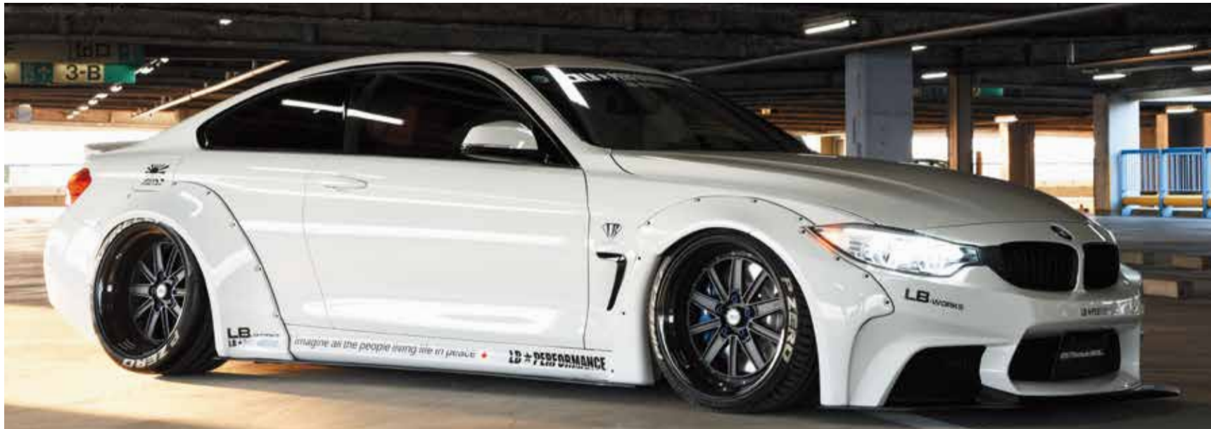
SIZE>>F:19×10.5J 5NR (275/30-19) R:19×12.0J -19HP (305/30R19) COLOR>>FLAT BLACK ※オーバーフェンダーが必要です。
