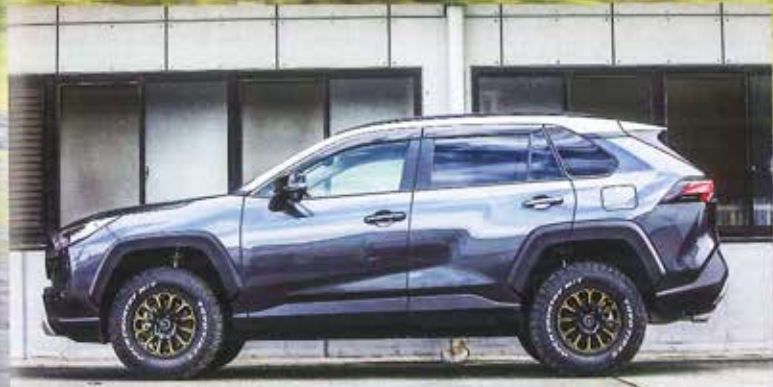
車高を上げて伸び出しストロークはしっかりと確保されている。よりインパクトのあるアゲ系スタイルを望むのなら車高調がオススメ
