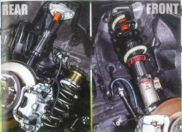
ショックは十分なストロークを確保したロングケースタイプ。車種ごとに足まわりの構造を分析してアゲ系専用の車高調に仕立てている。写真は試作品だ
