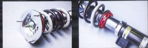
フロントのアッパーマウントはキャンバー調整式。車高を上げるとキャンバーはポジティブ側に傾くので矯正してやりたい ローダウン用車高調で増った全長調整式。ショックのストロークを犠牲にすることなくフラケット側で車高が調整できる
