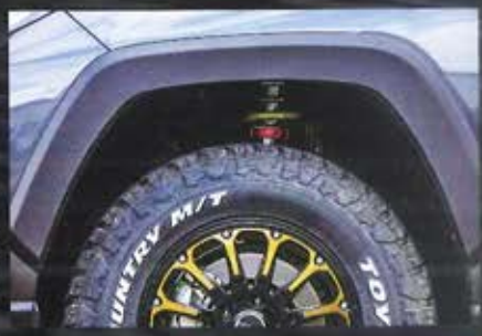
車高はノーマルからフロントが+46mm、リヤが+47mmまで上げることが可能。最高値にすれば荒れたオフロード走行も楽しめる
