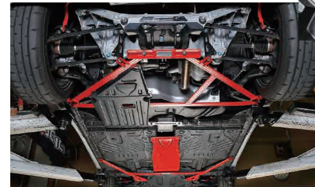
前後ともシャフト部分はタナベのラインナップするアイテムと同様だが、ベースプレートには剛性向上を図る3D形状を採用したS660用タワーバー。
