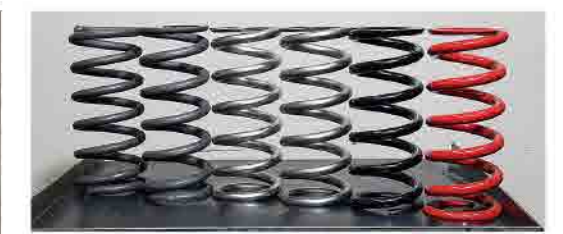
tanabeのカスタムスプリングはコイルリング、低温ブルーイング(低温焼きなまし)、ダブルショットピーニング、セッチング、下地処理に粉末塗装と多数の工程を経て仕上げられる。出荷前の最終検査はもちろんだが、各工程においても自由長など設計通りの仕上がりにしているかを全数チェック。製品に絶対的な自信を持っているからこそ、カスタムスプリングのSUSTEC、GT、DEVID Eにはへたり永久保証が与えられているのだ。
