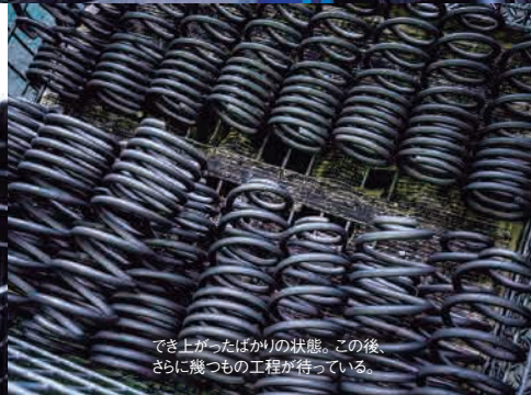
鋼材の特性を最大限に引き出す冷間製法。常温で成形していくのだ。
